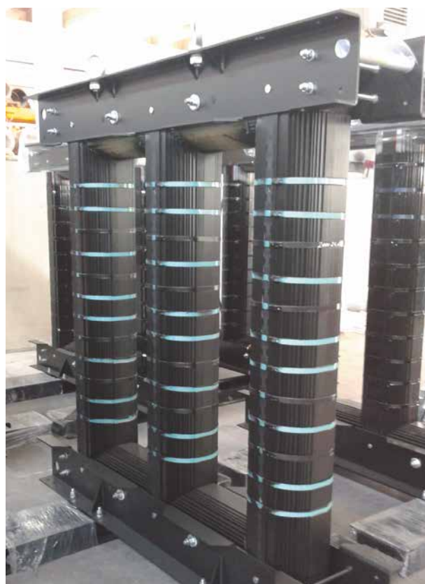
Ejemplo de núcleo magnético
