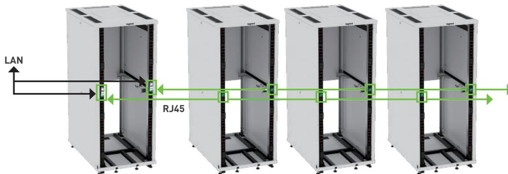
Ilustración de implementación con una cascada en la fuente A y otra en la fuente B.
