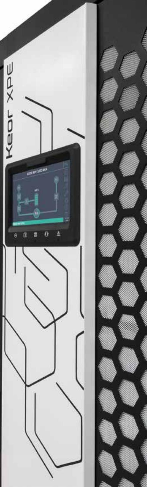
**Keor XPE** es un sistema de UPS modular ideal para sus necesidades de suministro. Se pueden añadir hasta 7 unidades de potencia al módulo de bypass principal (IOBM), cada uno de 250 o 300 kVA.
